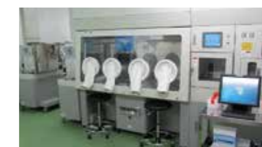
細胞調製ユニット内のアイソレータ
