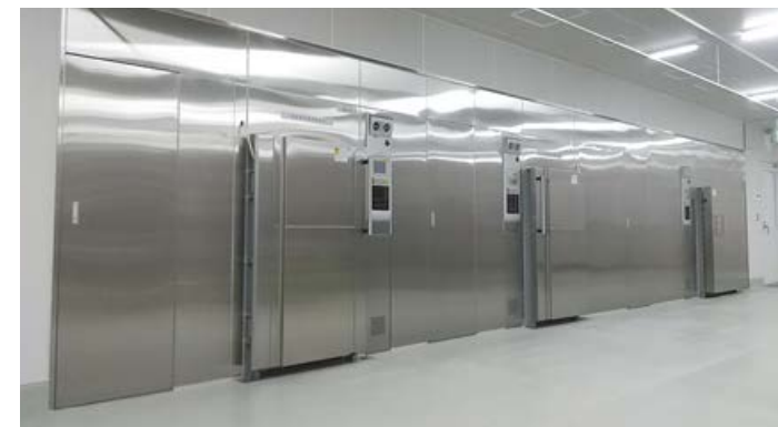
高圧蒸気滅菌装置
